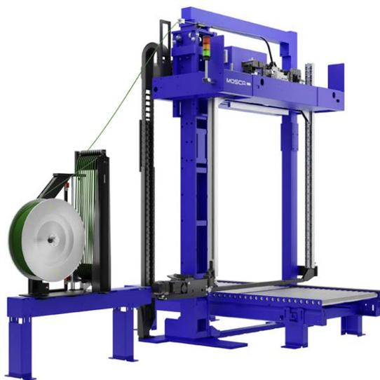
La **KZV-111** è una macchina reggiatrice robusta e durevole, adatta a pacchi pallettizzati di qualsiasi formato e forma che non richiedono compattazione. La testa di reggiatura SoniXs, montata in alto e alleggerita (32 kg), è fissata con chiusure rapide e può essere rimossa senza l'uso di attrezzi per operazioni di manutenzione.
