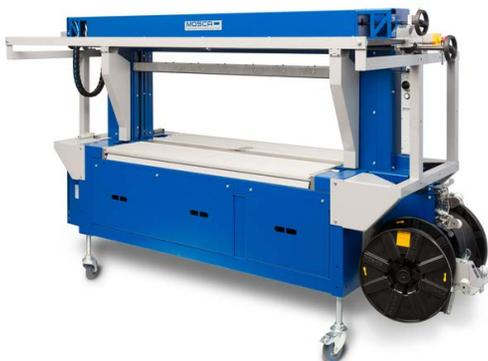
La **TRC-6** completamente automatica è stata progettata appositamente per applicazioni nel settore del cartone ondulato e della carta. Grazie alla struttura particolarmente ampia, la macchina è in grado di lavorare prodotti con una larghezza fino a 2.600 millimetri. Un dispositivo laterale di spinta opzionale e un arresto per i pacchi consentono inoltre un allineamento preciso del prodotto su cinque lati.
